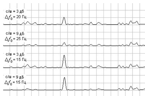
Рис. 2. Функция корреляции обнаружителя преамбулы при различных значениях отношения сигнал/шум и расстройки несущей частоты
