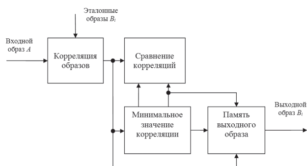
Рис. 3. Схема переборного декодирования образов
