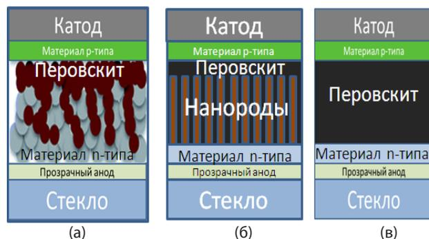
**Рис. 3.** Типичные архитектуры гибридных органо-неорганических перовскитных солнечных элементов: (а) с объемным гетеропереходом и мезопористым  $TiO_2$ ,  $ZrO_2$  анодным материалом n-типа; (б) с объемным гетеропереходом с упорядоченным наноструктурированным  $TiO_2$  или  $ZnO$  анодным материалом n-типа; (в) с классическим планарными гетеропереходами
