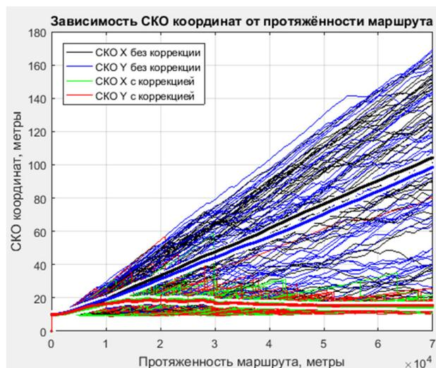
Рис. 2. Зависимость СКО координат от протяженности маршрута (утолщенные линии – средние значения СКО)
