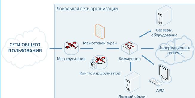
**Рис. 2.** Типовая структура организации с применением ложных сетевых информационных объектов
