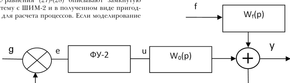
Рис. 4. Структурная схема системы с ШИМ-2
