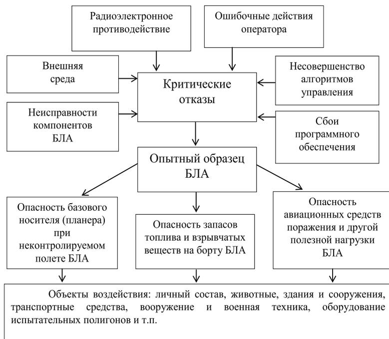
**Рис. 1.** Связь между источниками критических отказов и возникновением опасных ситуаций в ходе проведения испытаний БЛА
