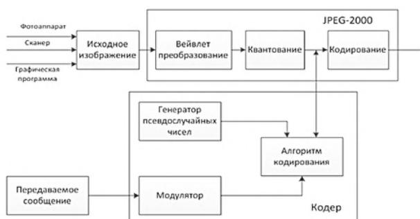
Рис. 1. Передающая часть системы скрытия
