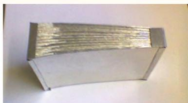
**Рис. 4.** Фотография пакета селективирующих элементов во 2-м и 3-м экспериментах
