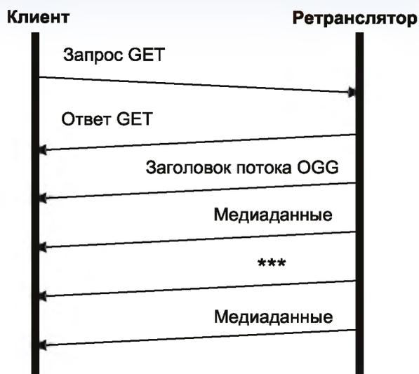
Рис. 5. Схема взаимодействия клиента и Ретранслятора
