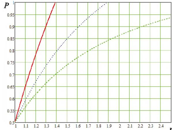
**Рис. 2.** Зависимости показателя надежности от коэффициента запаса при коэффициентах вариации:
