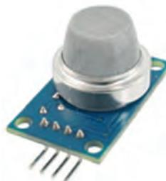
Рис. 1. Газовый датчик
