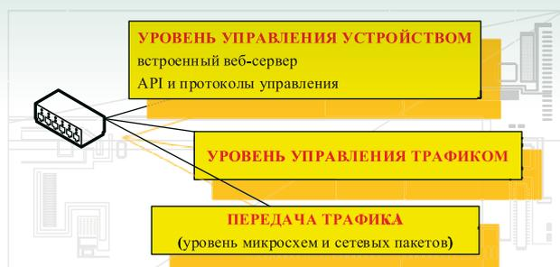
Рис. 1. Типовая архитектура сетевого оборудования
