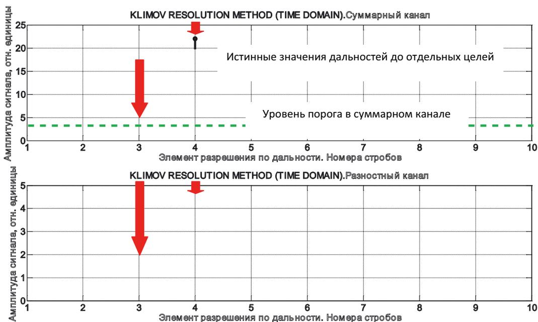
**Рис. 2.** Результат разрешения парной групповой цели по дальности в суммарном и разностном каналах РЛС с МИП. Отношение сигнал-шум 30 дБ.
