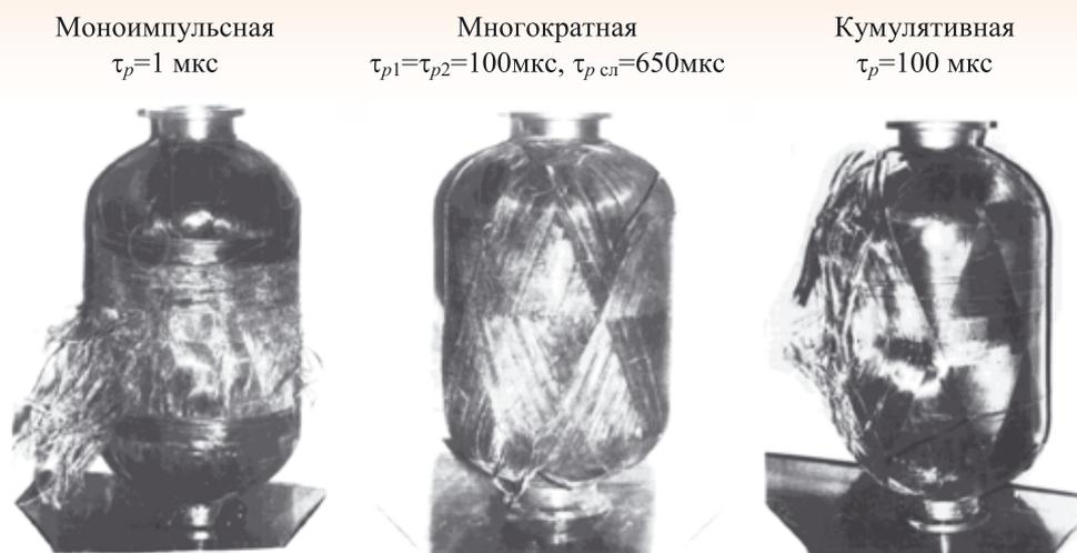
Рис. 6. Изменение характера разрушения в зависимости от пространственно-временного распределения нагрузки ( $I_{p\Sigma} = 0,01 \text{ кг с/см}^2$ )
