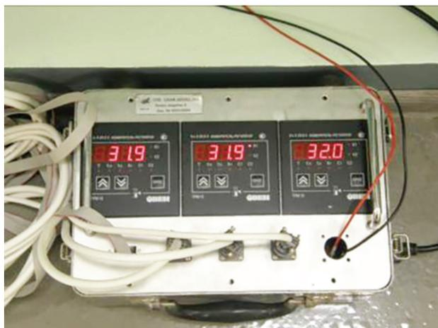
**Рис. 4.** Пульт управления обогревом теплового манекена
