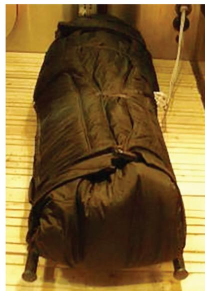
**Рис. 6.** Термоманекен готов к проведению испытаний
