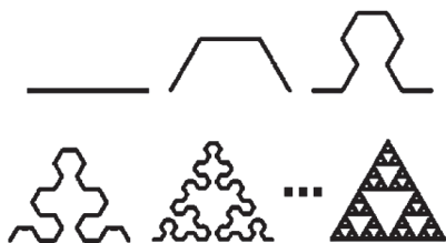
Рис. 2. Рекуррентная геометрическая процедура формирования треугольника Серпинского. Каждый акт приводит к увеличению длины линии в полтора раза. Габариты ТС оказываются ограниченными
