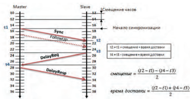
Рис. 1. Синхронизации по времени в локальной сети EtherCAT
