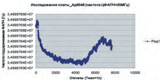
Рис. 4. Изменение собственной частоты цифрового контура ФАПЧ ( f_s=35 МГц)
