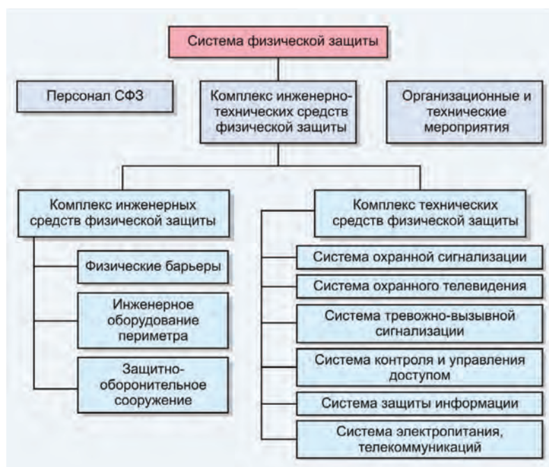
Рис. 1. Обобщенная структурная схема системы физической защиты объекта
