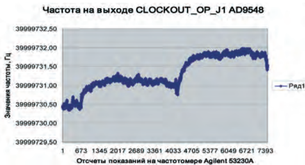
Рис. 3. Изменение собственной частоты цифрового контура ФАПЧ ( f_s=40 МГц)
