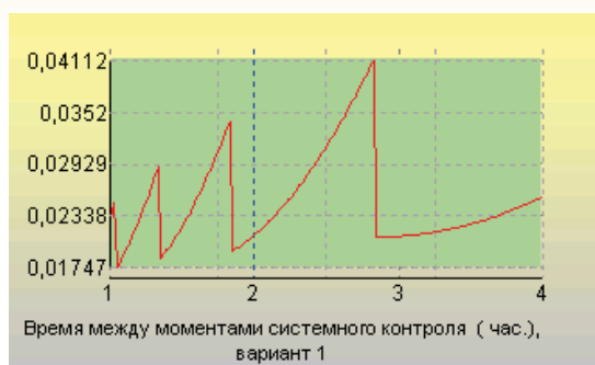
Рис. 11. Зависимость риска пропуска критических отклонений в обеспечении доступности и целостности от характеристики «время между моментами системного контроля»
