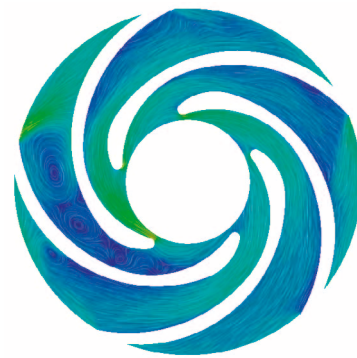
(е) Уменьшенный выходной угол лопатки
