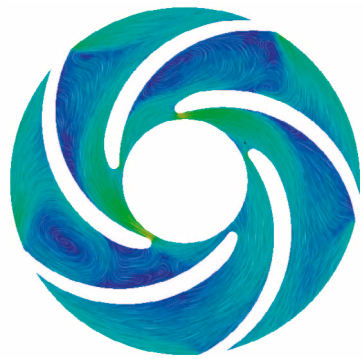
(д) Увеличенный выходной угол лопатки
